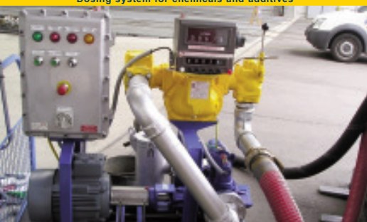
Mobiles Entladungssystem mit Zähler - EX Zone Mobile deloading system with counter - EX
